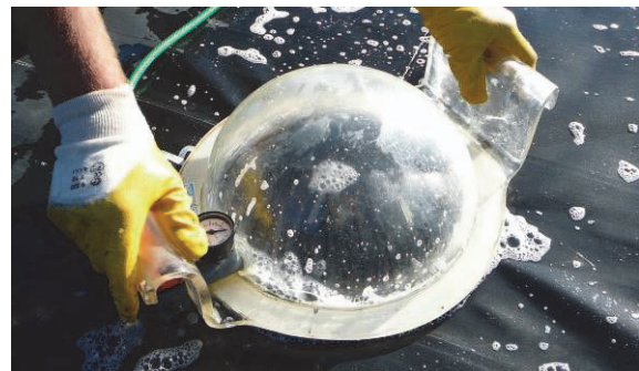
Figure 39. Protection contre les vagues Figure 40. Contrôle de qualité à la cloche à vide
